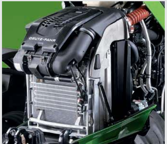
↑ PowerCore-Technologie für den Luftfilter: 20 % höhere Luftdurchsatzkapazität im Vergleich zu Standardfiltern.
