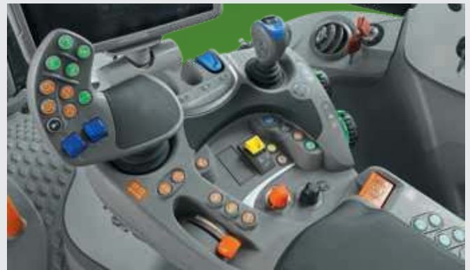
⬆ TTV Getriebe: Willkommen in der ersten Klasse mit optimalem Fahr- und Bedienkomfort. Exklusiv beim TTV-Getriebe: Frontkraftheber mit Positionssteuerung und elektronische Feststellbremse in der Armlehne integriert.
