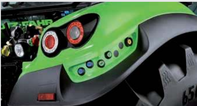
↑ Einfache externe Bedienung eines Hydraulikventils, des Heckkrafthebers und der Zapfwelle an beiden Seiten.
