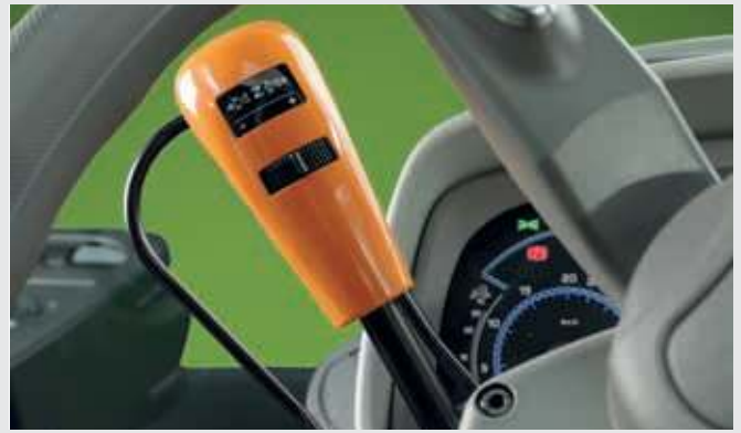
↑ PowerShuttle mit SenseClutch und fünfstufig einstellbarem Ansprechverhalten.
