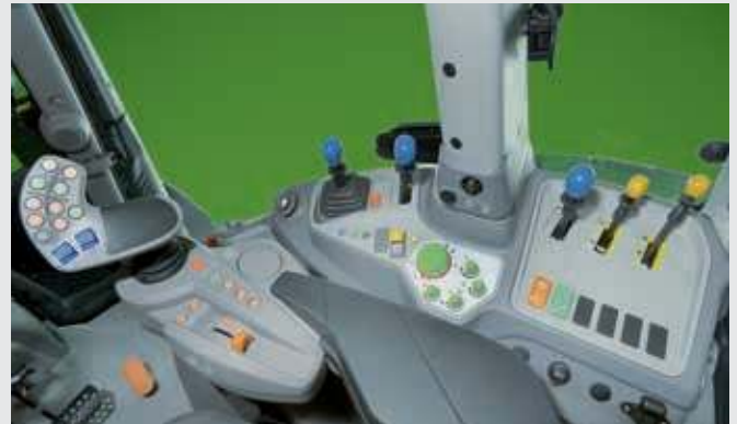
⬆ RCshift: Erhältlich als Variante mit mechanischen Steuergeräten oder als Variante mit Multifunktionsarmlehne, elektrohydraulischen Steuerventilen und iMonitor.
