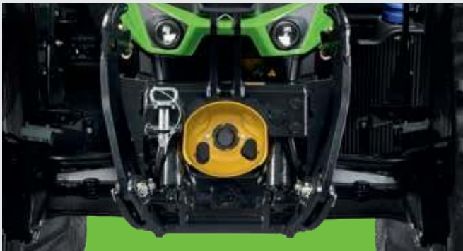
↑ Positionsgesteuerter Frontkraftheber mit bis zu 5.450 kg Hubkraft (TTV-Modelle).
