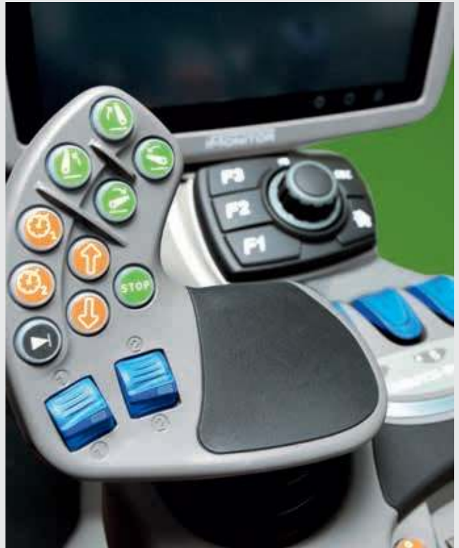
↑ Mit zwei Tempomat-Tasten auf dem MaxCom-Multifunktionsjoystick kann der Fahrer vier verschiedene Geschwindigkeitseinstellungen für Arbeiten auf dem Feld oder auf der Straße abrufen und eine konstante Geschwindigkeit für optimale Ergebnisse aufrechterhalten.
