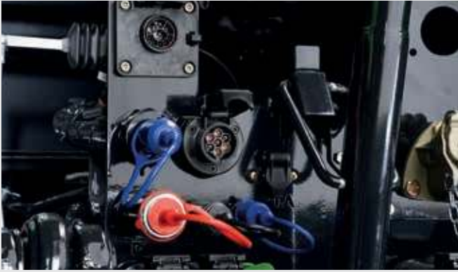
↑ Die DEUTZ-FAHR ISOBUS-Schnittstellen an Front und Heck machen den Traktor mit Anbaugeräten aller namhaften Hersteller kompatibel.
