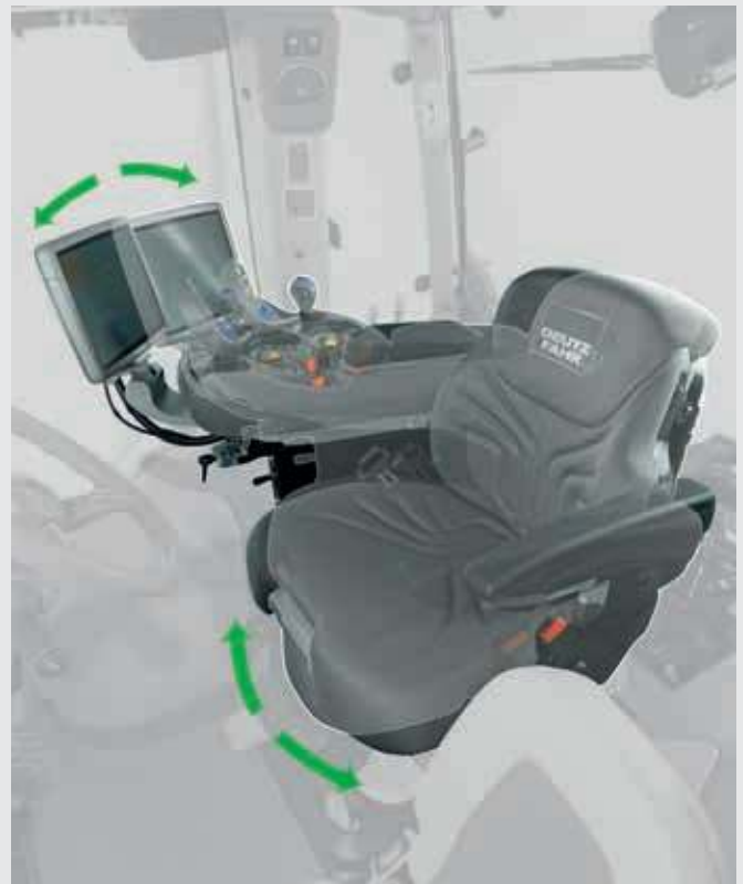
↑ Erhältlich für alle TTV-Modelle: Sitz bis zu 23° drehbar für mehr Komfort und Bedienerfreundlichkeit.
