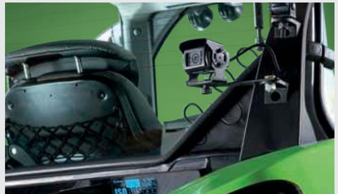
↑ Integrierte Kamera mit automatischem Vollbildmodus (z. B. beim Rückwärtsfahren) für bessere Übersicht und mehr Sicherheit.
