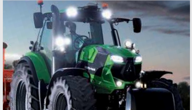
↑ LED-Paket mit bis zu 2.500 lm pro Arbeitsscheinwerfer (je nach Modell).
