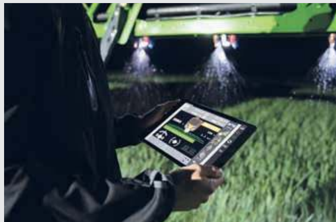
↑ XTEND-Funktion, die Bedienung von ISOBUS Anbaugeräten über ein Tablet auch außerhalb der Kabine.
