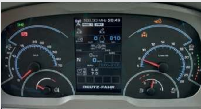
↑ Moderne Instrumententafel mit InfoCentre PRO : Hochauflösendes 5-Zoll-Display. Das verfügbare iLock-System sorgt für Sicherheit – Ver- und Entriegeln des Traktors mit einer PIN.
