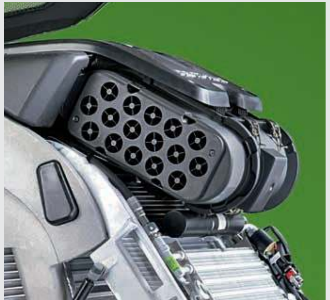
↑ Vorreinigungssystem im Motorluftfilter: Spiralförmige Zyklonen und eine Absaugung entfernen 95 % des Staubs, bevor er in den Primärfilter gelangt.
